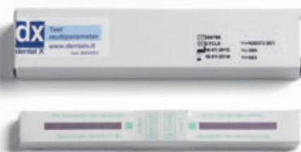
MP200 multiparametarni indikatori koji su u skladu s ISO 11140-1 pravilom, netoksični i bezolovni, osmišljeni su za procjenu parametara sterilizacije čitanjem jednostavnog i trenutnog tona boje.
